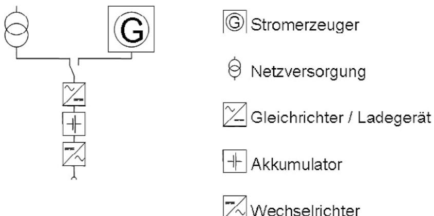
Abb. 4: USV – Anlage mit Stromerzeugerbetrieb
