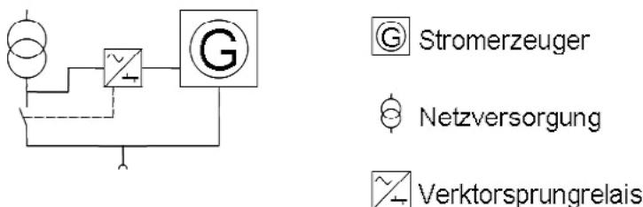
Abb. 5: Umschaltung Netz – Stromerzeuger mittels Vektorschaltung
